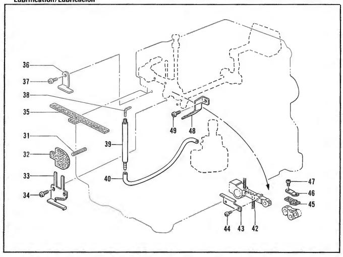
L. 針冷却装置/Needle cooler/Nadelkühlungsvorrichtung/ Mécanisme du refroidisseur d'aiguille/Mecanismo del enfriador de aguja
